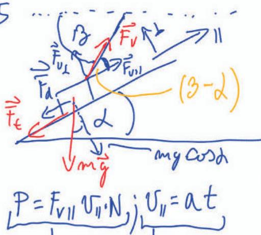
$$P = F_{v\parallel} \cdot v_{\parallel} \cdot N; v_{\parallel} = a t$$
